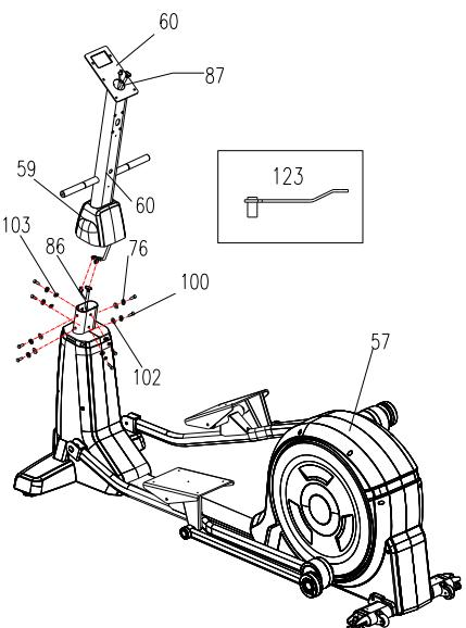
Откройте коробку и извлеките все составляющие части тренажера. Основание тренажера установите на ровную поверхность. Установите стойку консоли через кожух стойки консоли на основную раму, предварительно соединив между собой верхний и нижний кабели консоли. Закрепите при помощи винтов и шайб.
