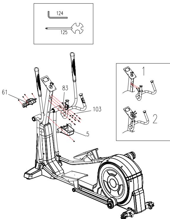
Установите руль на стойку консоли и закрепите при помощи болтов и шайб.
